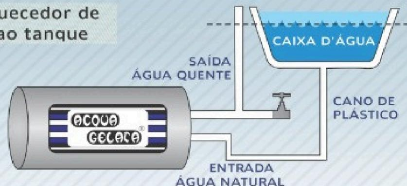
Obs.: Deve-se manter um recipiente embaixo da saída de água do aquecedor. Devido ao processo de aquecimento ocasionando descarga de água quente.
